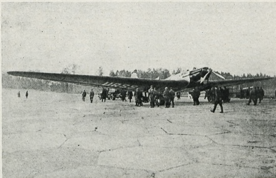
Sowiecki dolnopłat rajdowy „ANT-25”, na którym lotnicy Czkałow, Bajdukow i Bielakow wykonali blisko 10.000-kilometrowy lot arktyczny (por. poprz. numer Skrzydlatej). Aparat ma chowane podwozie i wyróżnia się wielkiem wydłużeniem płata. Rozpiętość — 34 m.
