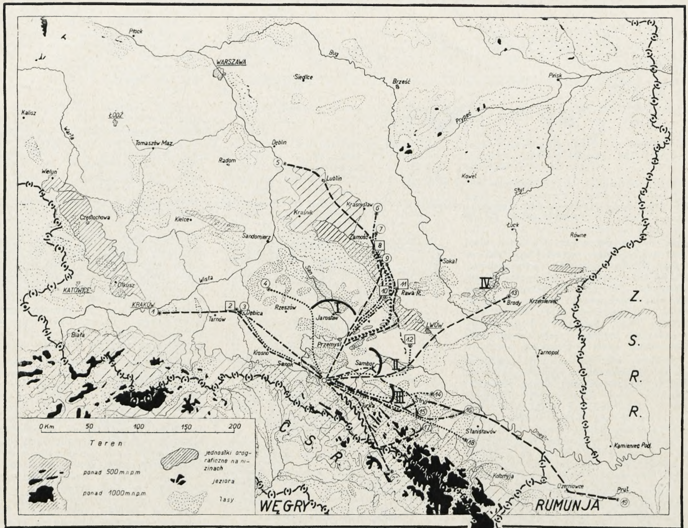
Rys. 14. Mapa rzeczywistych tras przelotów szybowcowych. Cyfry w kółkach oznaczają przeloty ponad 100 km z IV K. Z. S. (1936), cyfry w kwadratach — przeloty ponad 100 km z III K. Z. S. (1935). Łukami I, II, III zaznaczono granice licznych krótszych przelotów, pokrywające się z granicami obszarów ujemnej termiki. I — silnie nawodniona depresja Sanu koło Jarosławia. II — bagnista, bardzo szeroka dolina górnego Dniestru za Samborem. III — bagnaiste tereny Bystrzycy, Tyśmienicy i t. d. na N od Drohobycza. IV — bagna Styru koło Beres teczka, Łopatyna, Kamionki Strumilowej.
