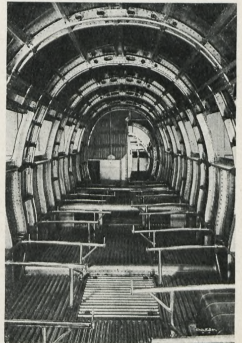
Wnętrze kadłuba. Podłoga i ścianki działowe — z blachy falistej. Widoczne są 3 rury, stanowiące pasy dźwigarów skrzydła.
