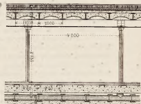
Ryc. 4 Normalny przekroj podbrzojny pod drewnianym brukiem.
