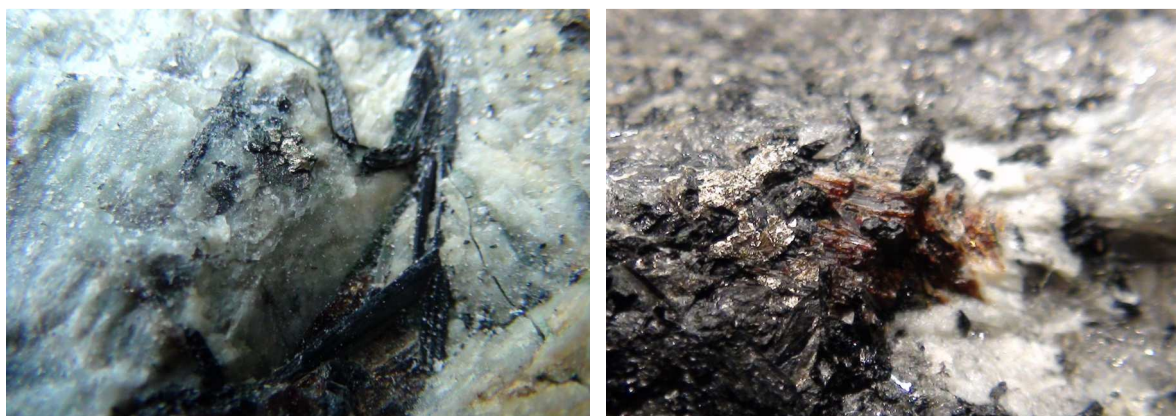
Ryc. 1. Mikrofotografie typowych sjenitów z Chibin: A - chalkopiryt widoczny na tle plagioklazów i ortoklazu oraz egirynu (próbka 01aCH12), B - rutyl oraz piryt z pentlandytem, widoczne na tle egirynu i plagioklazów (próbka 02CH12), C - kryształy siarczków na tle egirynu i nefelinu w sjenicie (próbka 01CH12), D - siarczki na tle egirynu, biotyту, arfvedsonitu i nefelinu (próbka 05CH12), (C-D - światło przechodzące, Nx).
