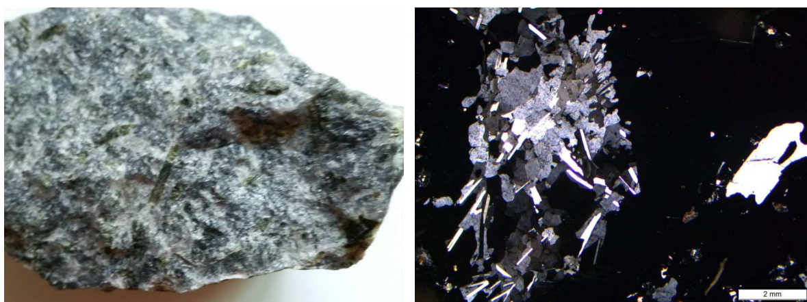
Ryc. 6. mikrofotografie piroksenitu wykonane za pomocą mikroskopu polaryzacyjnego (po lewej w świetle przechodzącym, po prawej odbitym).
