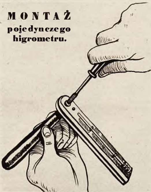
Higrometr składa się z dwóch zwyczajnych termometrów, zmontowanych grzbietami do góry na wspólnej drewnianej ręczce.
