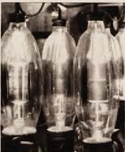
U góry: Porcelanowe izolatory, podtrzymujące przewody o wysokim napięciu. — U dołu: Zespół lamp modulujących w nadawczej stacji radiowej.
