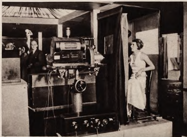
Aparat telewizyjny rozkłada obraz postaci „nadawanej” na poszczególne punkty.
