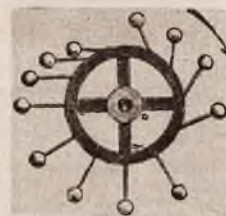
Cieżarki ruchome, osadzone na końcach ruchomych drążków, miały zapewnić ciągły ruch koła.
