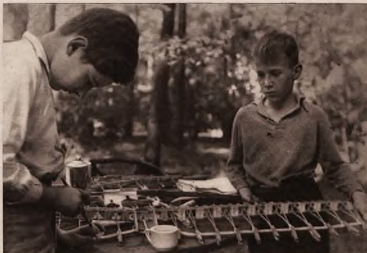
Przytwierdzanie z pomocą specjalnego kartonu i kleju ram skrzydeł do ich żeberek.
