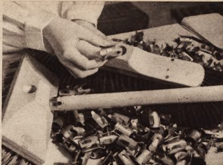
Metalowa okówka, założona w sposób uwidoczniiony na zdjęciu, powoduje silne umocowanie szczytów na drzewcu. Z wystawy „Dima” w Zurychu. Fot. Zygmunt Borzęcki. Zurych
