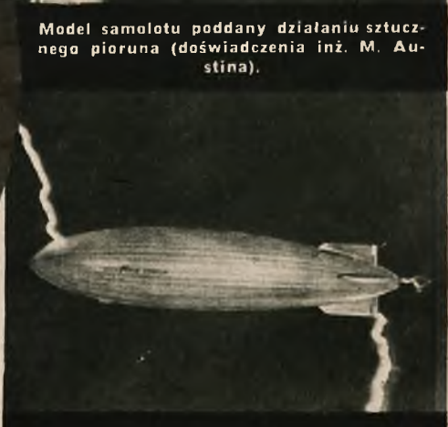
To samo doświadczenie inż. Austina, dokonane na modelu sterowca, (szkielet z duraluminium pokryty płótnem).
