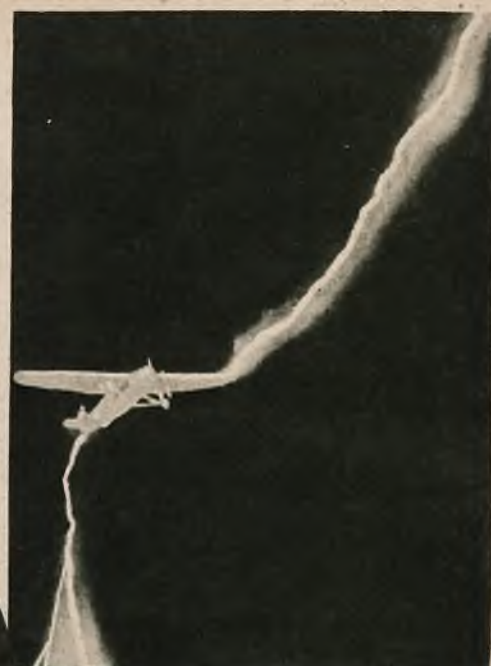
Model samolotu poddany działaniu sztucznego pioruna (doświadczenia inż. M. Austina).
