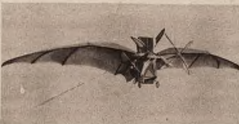
Muzeum Sztuki i Rzemiosła w Paryżu posiada ciekawy okaz samolotu wybudowanego w ostatnich latach XIX wieku. Samolot ten posiada dwa motory parowe o sile 20 HP każdy, i zaopatrzony jest w generator i kondensator parowy.
