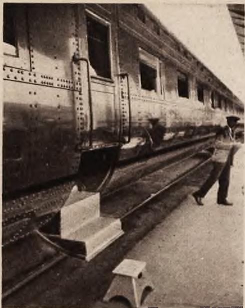
Drzwi i stopnie pociągu aerodynamicznego zamykają się automatycznie.
