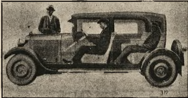
Samochód ośmiocylindrowy „Röhr”, którego podwozie tworzy jednocześnie podłogę karoserji.
