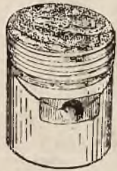
Osady węglowe, spowodowane używaniem niewłaściwego oleju lub materiału pędnego.
