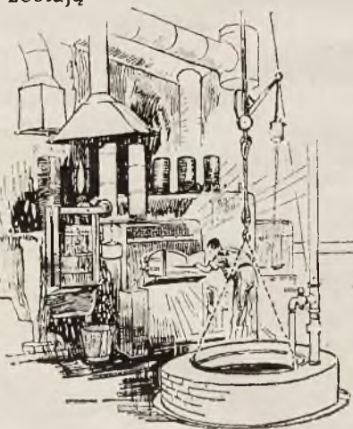
Kąpiel „piaskowa”. Walcowanie i hartowanie. Lakiernia: każda część wyjęta ze zbiornika z lakierem, zostaje zawieszona na hakach i przechodzi przez długi piec.
