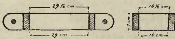
Przekroje poprzeczny i podłużny formy bez dna.
