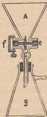
Rys. 50. Przekrój filtra do wody.
