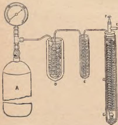
Rys. 11. Przyrząd Dewara do otrzymywania ciekłego wodoru.
