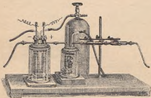
Rys. 14. Całkowite urządzenie aparatu Moissana.
