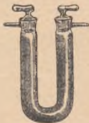
Rys. 55. Rurka do osuszania gazów.
