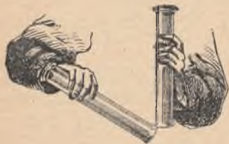
Rys. 10. Położenie naczyń przy przelewaniu wodoru.
