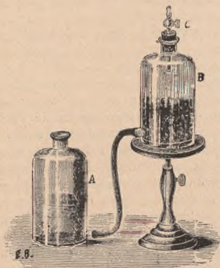
Rys. 105. Aparat do wywiązywania siarkowodoru.
