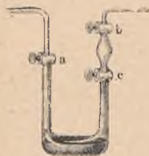
Fig. 109. Przyrząd do skraplania bezwodnika siarkawego.
