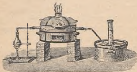
Rys. 5. Rozkład wody przez żelazo.
