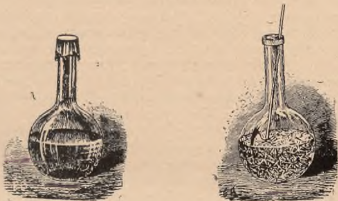
Rys. 100. Przesycony roztwór siarczanu sodu.
