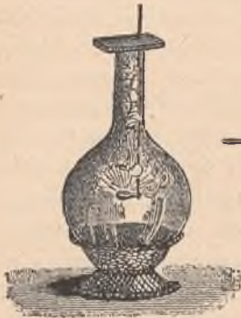
Rys. 27. Palenie się fosforu w tlenie.
