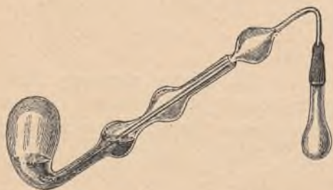
Rys. 16. Przyrząd do nasycania wody chlorem.
