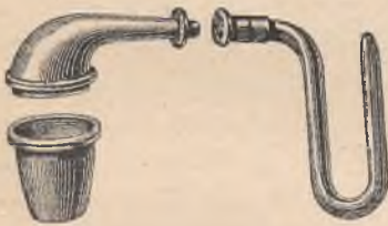
Rys. 20. Przyrząd do otrzymywania fluorowodoru.
