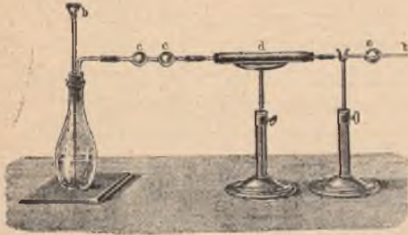
Rys. 12. Przyrząd do redukcji za pomocą wodoru.
