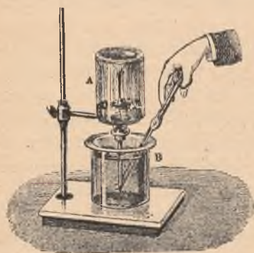
Rys. 21. Doświadczenie, wykazujące rozpuszczalność chlorowodoru w wodzie.
