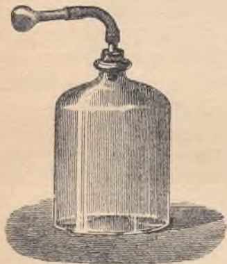
Rys. 18. Przyrząd do połączenia antymonu z chlorem. Z chwilą, gdy wysypiemy antymon z kolby do butelki, zapali się on, przyczem będą się wydzielały gryzące dymy trójchlorku antymonu. Chlor niszczy różne barwniki organiczne, wskutek czego stosowanym jest do bielienia papieru, płótna i t. p. Należy jednak stosować go z wielką ostrożnością, gdyż nadmiar chloru może szkodliwie podzia-
