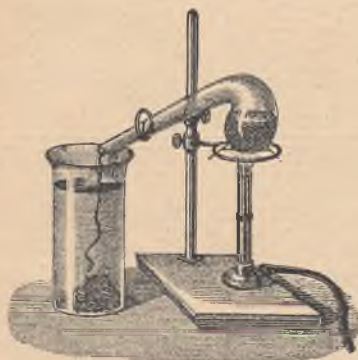
Rys. 44. Przyrząd do sporządzenia siarki plastycznej.
