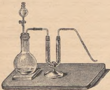
Rys 22. Przyrząd do wywiązywania bromowodoru.
