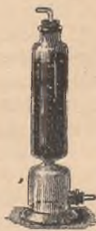
Rys. 56. Cylinder do osuszania gazów.
