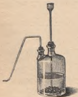
Rys. 7. Najprostszy przyrząd do otrzymania wodoru.
