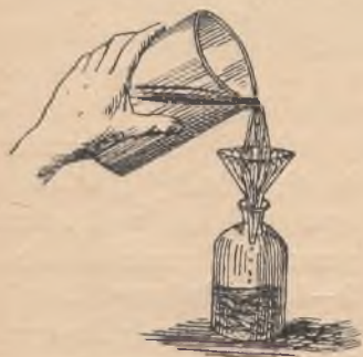
Rys. 48. Filtrowanie wody przez bibułę.
