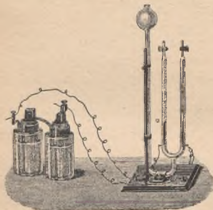
Rys. 6. Przyrząd do rozkładania wody prądem elektrycznym.
