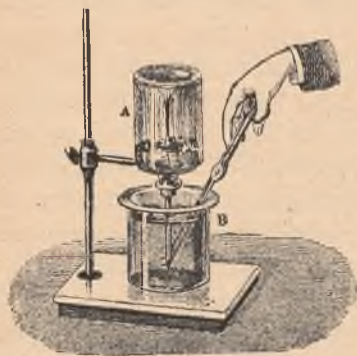
Rys. 21. Doświadczenie, wykazujące rozpuszczalność chlorowodoru w wodzie.
