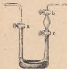
Fig. 109. Przyrząd do skraplania bezwodnika siarkawego.
