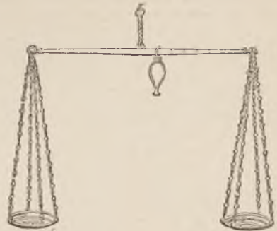
418. — Balance à poids mobile, trouvée à Pompéi.
