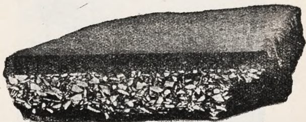
Rys. 13. Przekrój nawierzchni monolastikowej.
