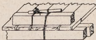
Rys. 7. Krawężnik przywiązany, z użyciem krępulca.
