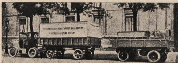
Rys. 4. Ciągnik z przyczepką narzędziową i z przyczepką ze zbiornikiem wody.
