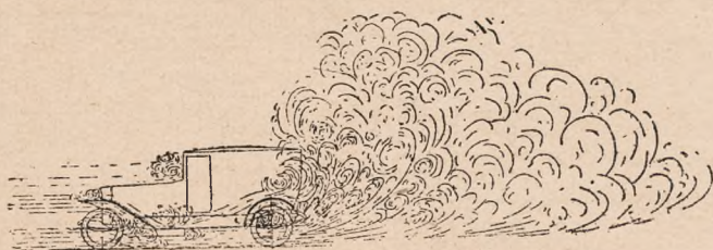
Tumany pyłu za samochodem jako widoczne skutki powstawania szkodliwych wirów powietrznych.
