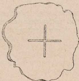
Rys. 15. Szczelina obserwacyjna w pancerzu samochodu pancernego Peugeot wycięta w kształcie krzyżyka.
