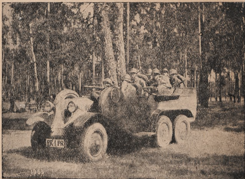
Samochody lekkie sześciokolowe (trzyosiowe) używane do przewozu straży bocznej w armji jednego z sąsiadujących państw.
