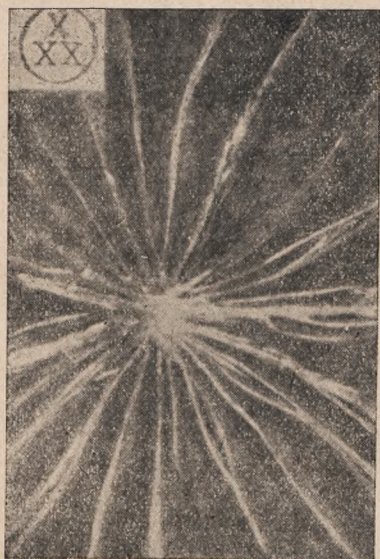
Rys. K. Szkło „Triplex“ uderzone młotem pękło, lecz zachowało swą spoiwość.
