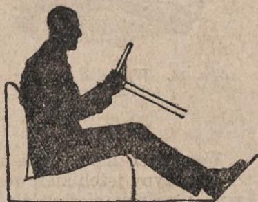
Rys. 20. Właściwe ustawienie poduszki i oparcia siedzenia dla kierowcy.
