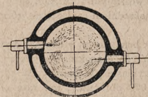
Rys. 3. Wiry wytwarzane w silniku „M. A. N.” przez mimośrodkowe umieszczenie wtryskiwaczy.
