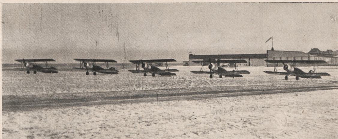
Serja pierwszych 5 płatowców szkolnych BM 4 a, z silnikiem „Le Rhone“, z serji 22 płatowców zamówionych przez Departament Lotnictwa. „Samolot“ S. A. Poznań.
