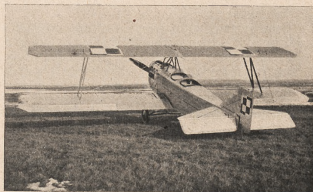
BM55 platowiec przejściowy — silnik: SPA. 200 MK. „Samolot“ S. A. Poznań.
