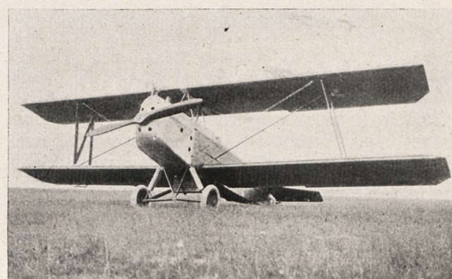
Płatowiec przejśc.: „Bartel“ M5a silnik: „A-Daimler“ 22 MK. „Samolot“ S. A. Poznań.
