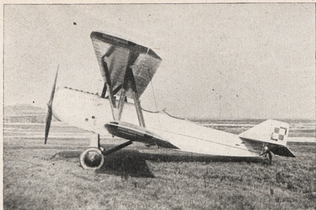
BM5b płatowiec przejściowy — silnik: SPA. 200 MK. „Samolot“ S. A. Poznań.
