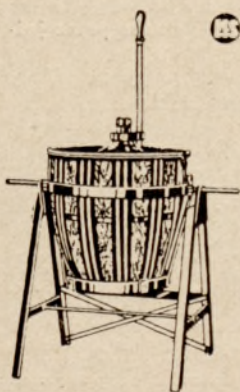
Rys. 3. Wywrotnica do balonów z kwasami i cieczami palnymi
