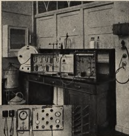
Fragm. pracy toksykologicznej. Aparatura do oznaczenia tlenu w powietrzu i par węglowodorów (fot. PAT)
