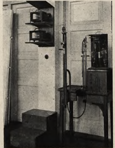
Aparat Haldane'a do analizy powietrza na zawartość tlenu i dwutlenku węgla (fot. PAT)
