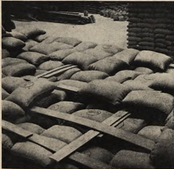
Z lewej strony — sposób układania worków i wiązania sztapli deskami (od 6 worków wzwyż, co 6 worków, deski układane w kratę w odstępach 1,5–2 m); z prawej strony — sztaplowanie worków z nasionami (układanie desek w czworobok)
