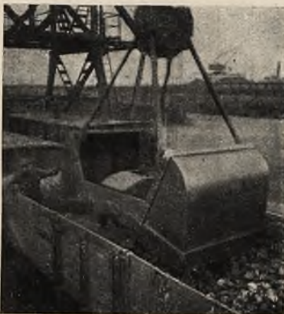
(14) Wyładunek węgla z wagonu na statek przy pomocy dźwigu z chwytakiem. Robotnik popycha chwytak do węgla, aby zaczerpnąć ładunek
