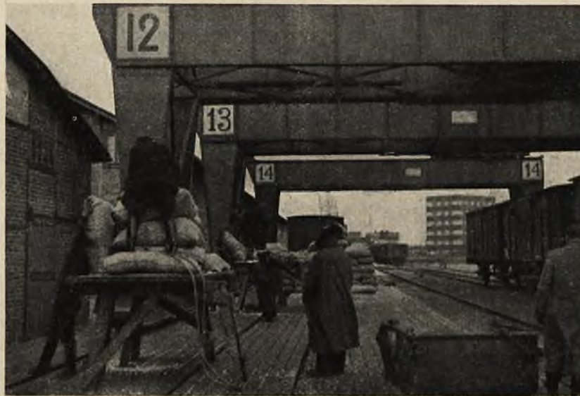
(8) Wyładunek towarów w workach przy pomocy lin (sztropów) i koźłów (sztelazy) w chwili, gdy hive został zdjęty z haku dźwigu, a robotnicy na koźle podają innym worki na plecy
