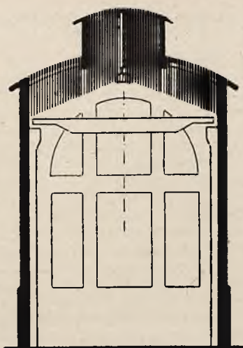
Oprawa zbyt rozwarta — zbędne oświetlenie ścian
