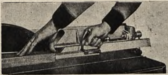
Rys. 5 Użycie prowadnicy położonej płasko na stole
