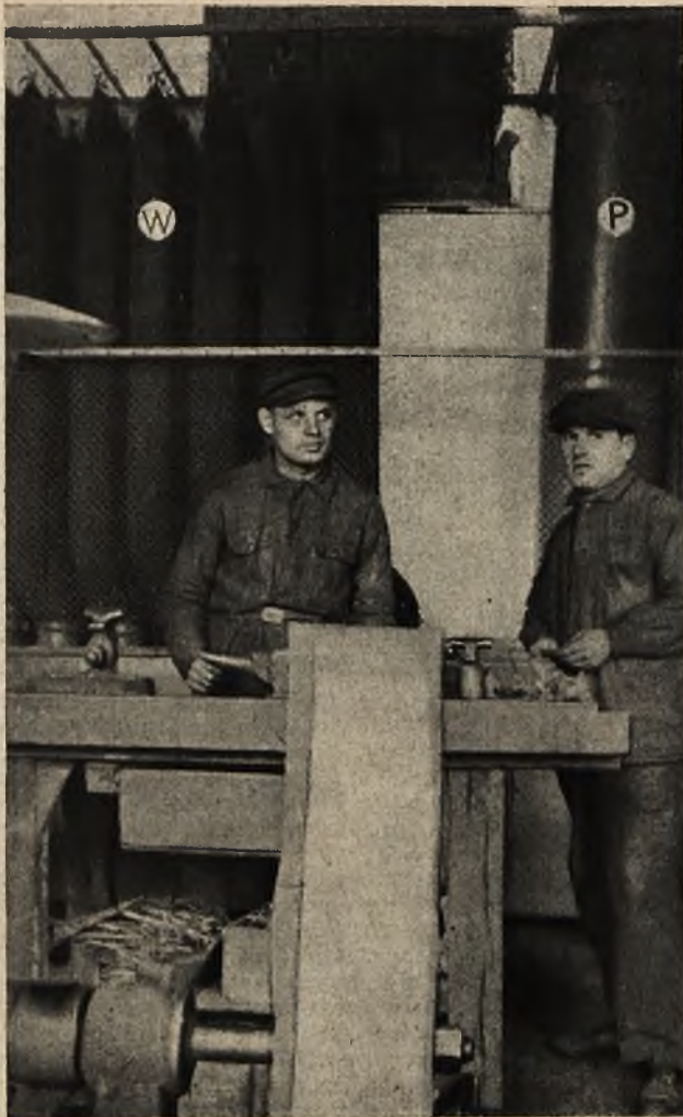
W — worki filtrujące powietrze; P — przewód tłoczący
