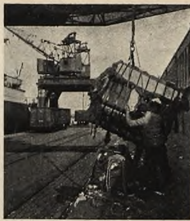
(5) Wyładunek bawełny przy pomocy lin (sztropów) w chwili przyjmowania na lądzie przez robotników. Hłve zawieszony na haku dźwigu związany jest nieprawidłowo: niezaciągnięty pętla, sztrop niedobity
