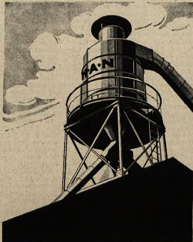
Z lewej strony: osadnik zainstalowany w Wzorcowni Urzędzeń Ochronnych w Warszawie, z prawej strony: duży osadnik typu „Cyklon” do zbierania kurzu i nieczystości
