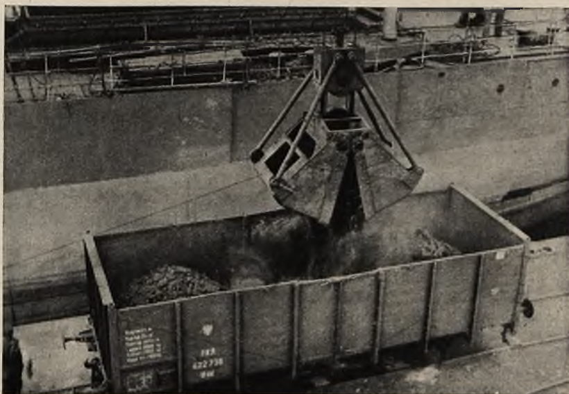
(12) Wyładunek rudy na wagon przy pomocy chwytaka w chwili otworzenia napelnionego chwytaka i wyrzucenia zawartości do wagonu
