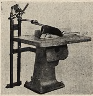
Rys. 3 Kaptur SUVA umocowany do podłogi. Zasięg do 700 mm
