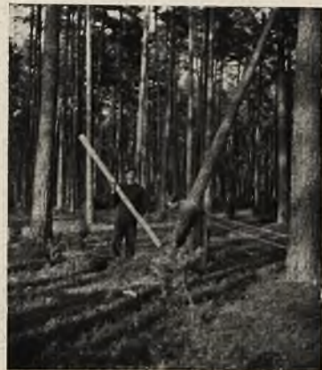
Moment zaczepienia drzewa przed ściąganiem go przy pomocy lisicy automatycznej
