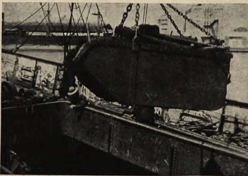
(4) Wyładunek złomu żelaznego przy pomocy szufli (toby). Toba napełniona złomem w chwili wyciągania dźwigien z luki statku
