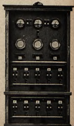
Rys. 6 Odbiornik obsługujący 10 pętlic sygnalizacyjnych
