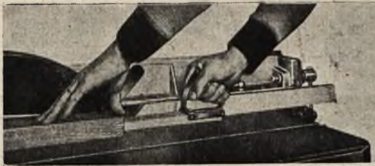
Rys. 5 Użycie prowadnicy położonej płasko na stole
