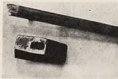
Rys. 5a Fotografia z podpisem: „ten młot złamał się dn. 17.XII 37 i skałeczył pracownika. Sprawdzajcie czy wasze młoty są dobrze opravione”
