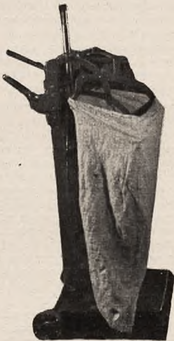
Podtrzymywacz na worki. Napełnione worki podnosi się na platformie dolnej przy pomocy korby. Ułatwia to „podstawienie się” pracownika przenoszącego worki (eksp. Wzorcowni)
