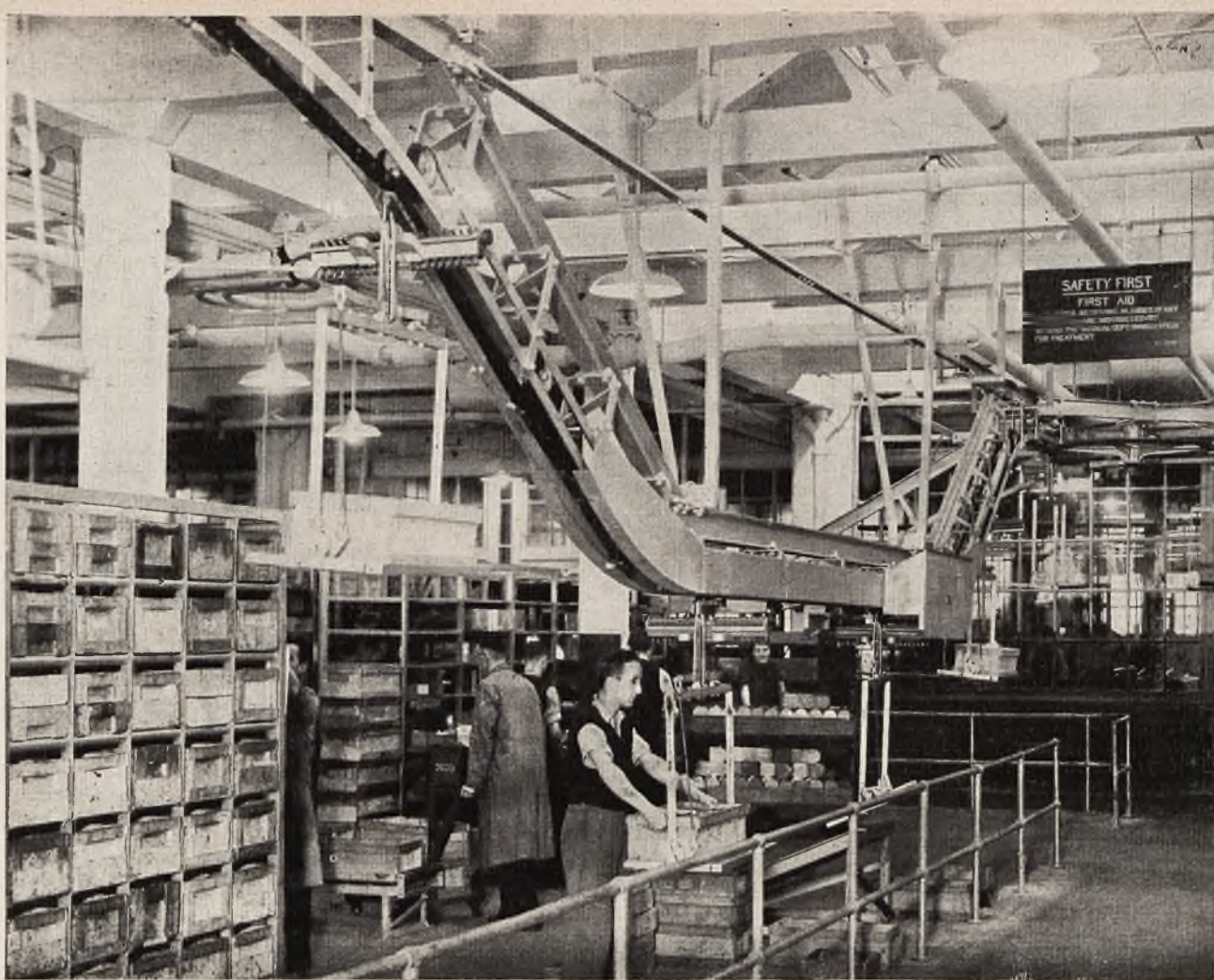
Fotografia powyższa obrazuje urządzenie ochronne, przeznaczone dla części transportera podstropowego w wytwórni. Instalacja ta służy do transportu wewnętrznego w dużej fabryce i jest urządzona w ten sposób, by pomosty ładunkowe można było obniżyć do odpowiedniej wysokości dla załadunku. W celu ochrony od zetknięcia się niektórych części ruchomych transportera z ludźmi stojącymi na podłodze stosowane są następujące urządzenia: przede wszystkim łańcuch i biegnące po szynach koła przenośnika są całkowicie osłonięte; poza tym bariera odgranicza ruch ludzi od niebezpiecznych miejsc. (Fot. Safety First Association)
