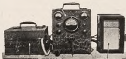
Rys. 1 Zespół przyrządów do analizy gazu przy pomocy komórek radioaktywnych
