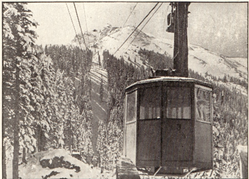
Wagonik może pomieścić 30 osób. Dla bezpieczeństwa wagonik posiada specjalne urządzenia hamulcowe oraz ratownicze.
