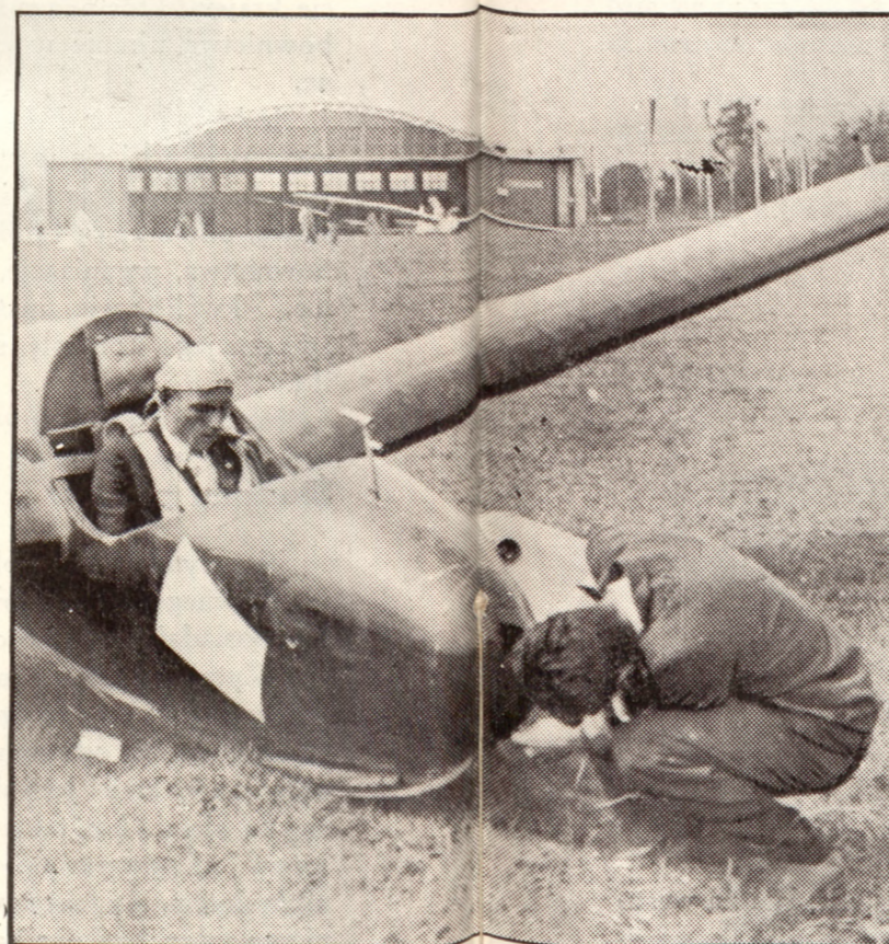
Szybowiec przymocowuje się do samolotu za chwilę samolot, wystartowawszy, wznosi szybowiec w górę, poczym na wysokości paruset metrów następuje szarpnięcie; samolot ląduje, zrzuca linkę, a szybowiec „idzie na przelot“.
