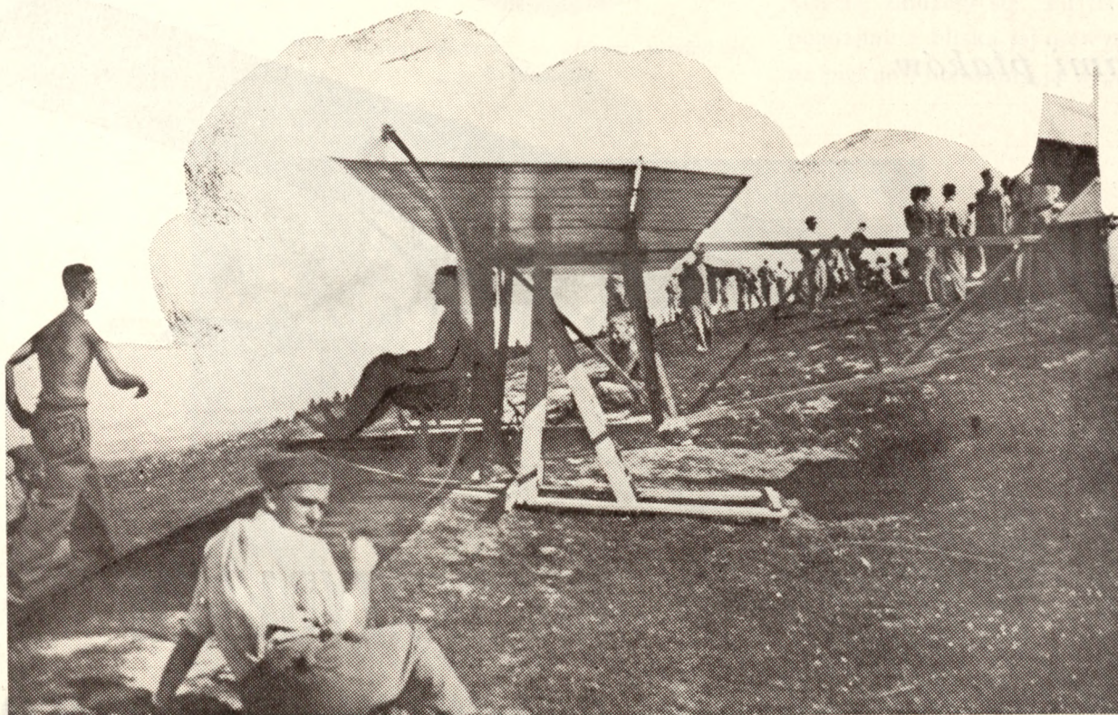
Szkolenie młodych szybowników. Szybowiec szkolny ustawiono na „chwicie”. Żołnierz z boku wychyla go z poziomu i kierunku, pilot zaś za pomocą steru przywraca szybowiec do równowagi.
