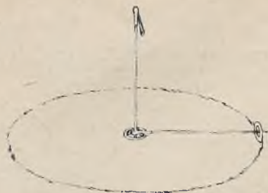
Jak wymierza się fundament pod igloo okrągłe
