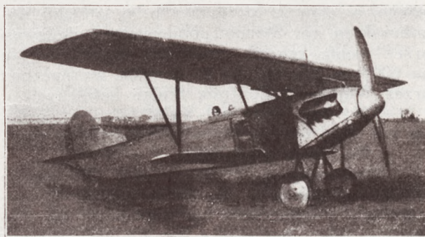
Typ samolotu myśliwskiego—Fokker XIII Szybkość max. — 265 km/g. Szybkość min. — 95 km/g. Szybkość wznoszenia na 5000 m. — 12 minut. Pułap— 8000 m. Silnik Napier „Lion” 470 KM.
