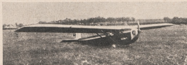
Beardmore „Wee-Bee” z silnikiem Bristol Cherub, zdobywca pierwszej nagrody w Lympe w r. 1924.
