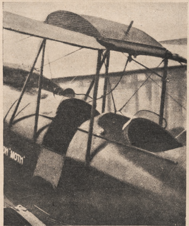
Baldachim „Moth'a”. Dobrze widoczny jest zbiornik z blachy falistej i drzwiczki przedniego siedzenia.
