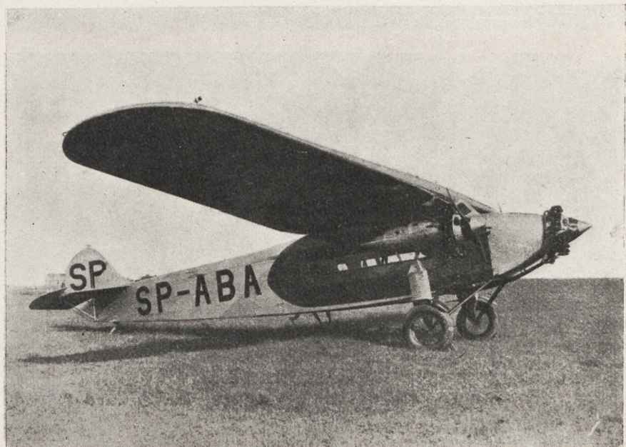
Trójsilnikowy Fokker F VII zbudowany w Zakładach Plage i Laśkiewicz w Lublinie. Samoloty tego typu użyte będą na linii Bukareszt-Warszawa.
