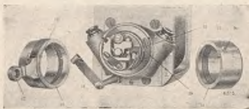
Rys. 5. Na lewo—pierścień przps. z przestawieniem mom. zapłonu; na prawo—tenże pierścień z zapłonem niezmiennym; w środku—dolna część aparatu zapłonowego
