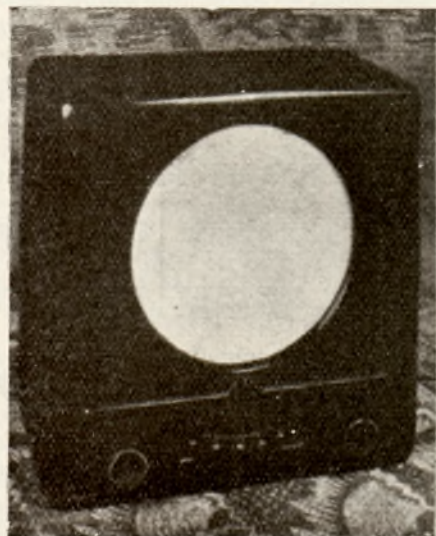
1 Wymiary zewnętrzne DKE 1938: wysokość — 23 c., szerokość — 22 c. i grubość — 11,5 c.
