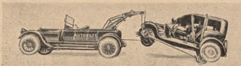
Samochód ratunkowy z aparaturą „Levator”. Nośność 2.500 kg.
