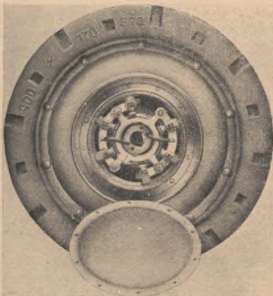
Silnik elektryczny, umieszczony w kole, widziany od strony szczotek
