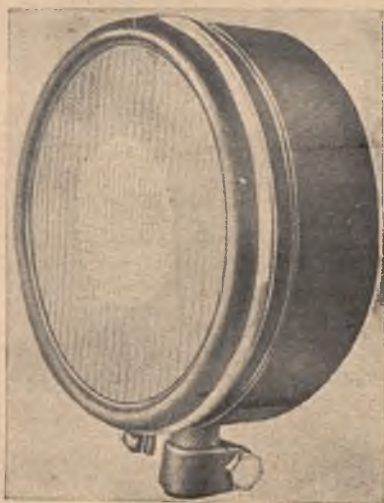
Reflektor produkcji Westfälische Metall-Industrie A. G. z ryflowaną szybą.
